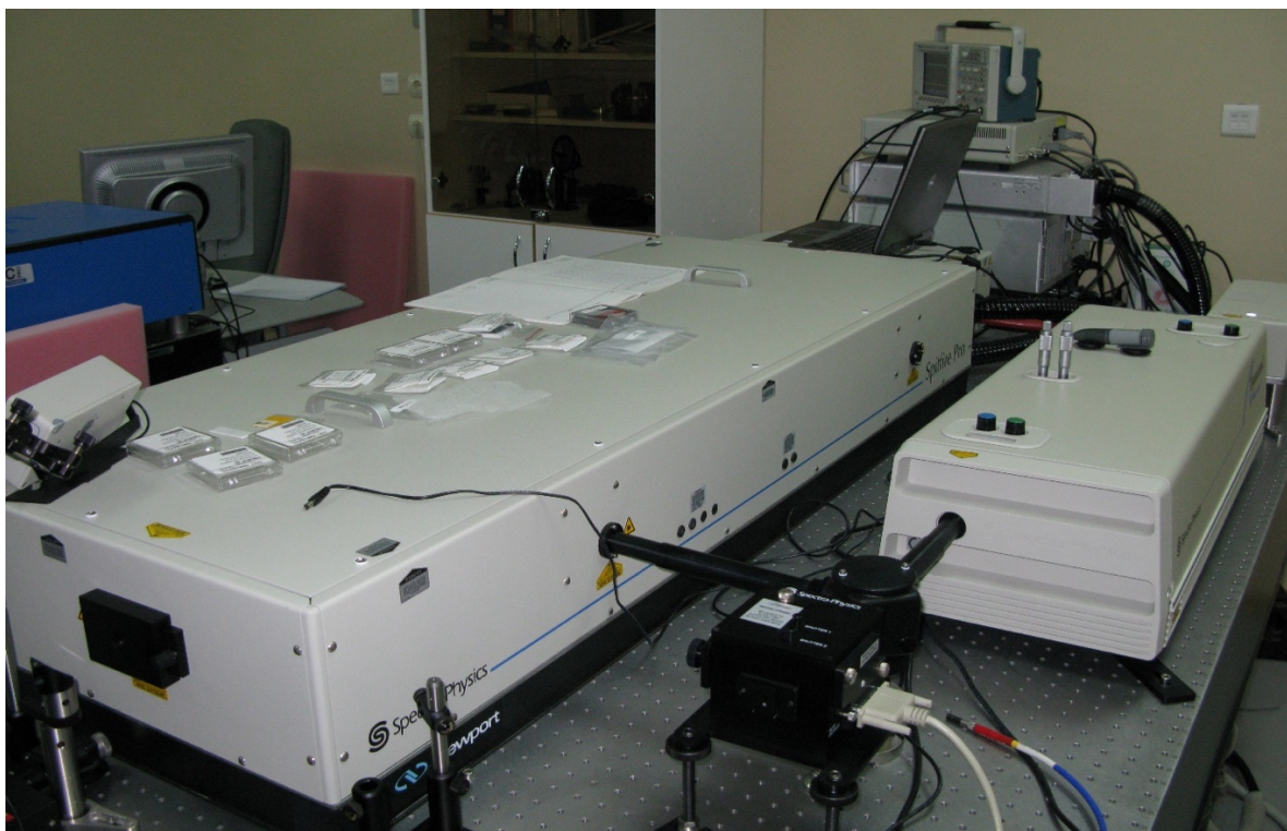
Рис.2.1.5. Фемтосекундный лазерный комплекс №1 Spitfire Pro 40F
